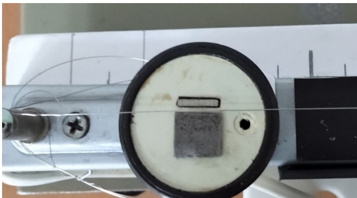
Фото 2. Адаптер – электромагнит и струна между его полюсами
