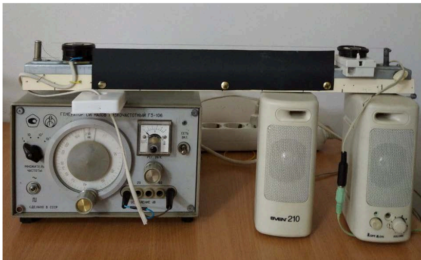
Фото 1. Экспериментальная установка для исследования тембра музыкального звука на примере стальной струны.
